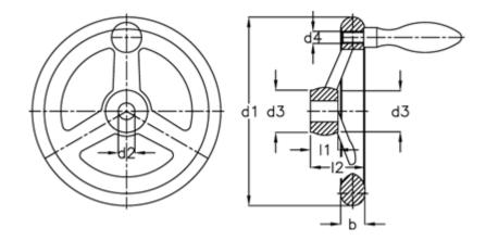
b = 18 d1 = 160 d2 H7 = 14 d3 = 33 d4 = M 10 Handle  $\overline{\phantom{0}}$  = 25 l1 = 20 l2 = 40
